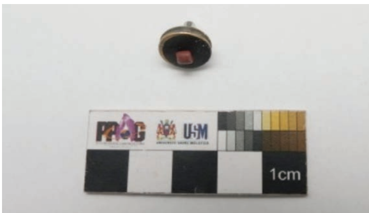
Foto 3 Manik dilekatkan pada stub untuk analisis SEM/EDX.
